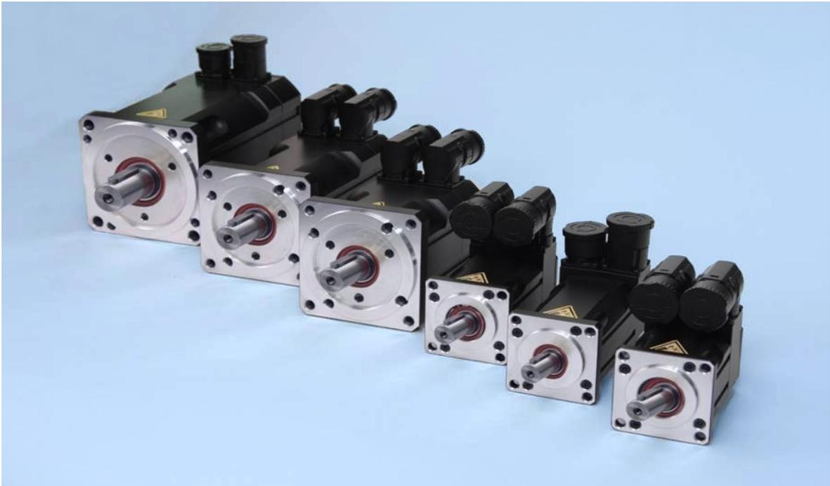
AC-Servomotoren von 0,25 bis 54 Nm Nennmoment in fünf verschiedenen Flanschgrößen, Nenn-drehzahlen bis 6.000 min<sup>-1</sup> andere Drehzahlen auf Anfrage. Alle Motoren sind mit Bremsen lieferbar.
