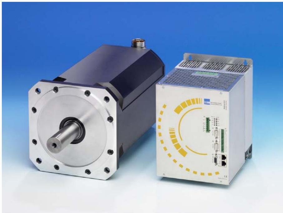
**Der Servoantriebs-Spezialist ESR Pollmeier erweitert seine Servoregler-Baureihe MidiDrive D/xS. Mit Geräten für 16 und 32 A Nennstrom (entspricht 32 bzw. 64 A Spitzenstrom) werden nun auch Servoanwendungen im höheren Leistungssegment abgedeckt. Kommunikativ sind die Großen wie die Kleinen: zur Auswahl stehen EtherCAT, Profibus-DP, CANopen und analoge Schnittstelle.**
